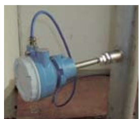
Proline t-mass 65 in getrennter Ausführung im Einsatz
